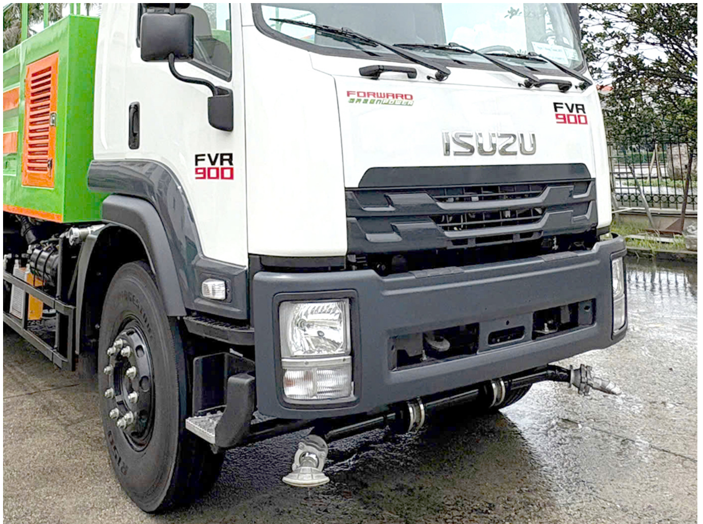
Ảnh Bếp phun rửa đường kiểu tay trang bị ở đầu xe
