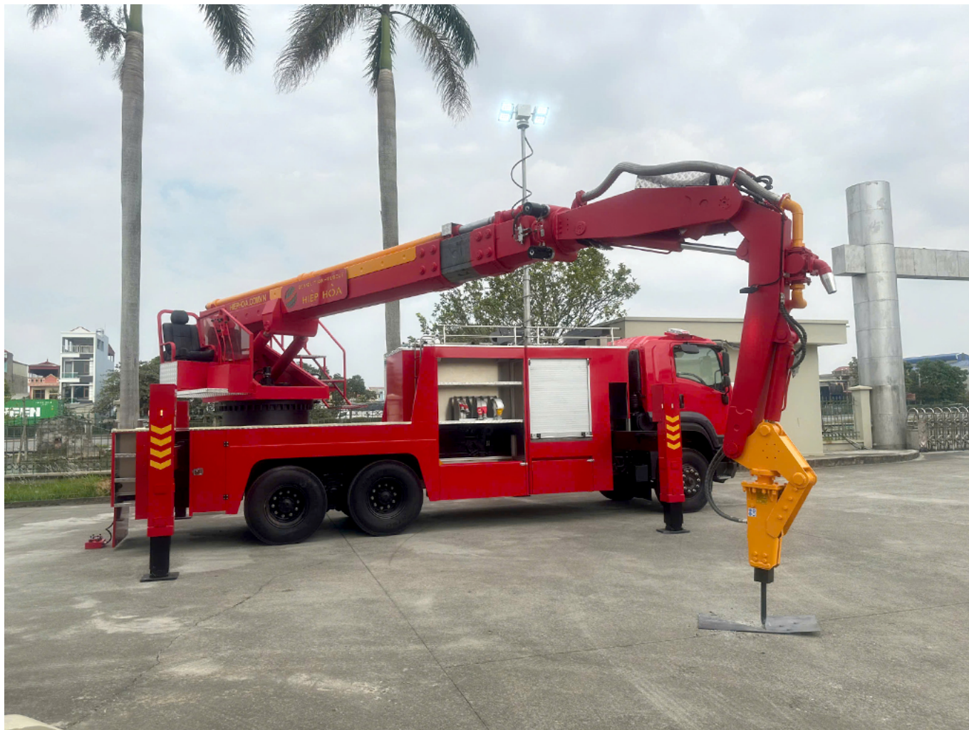
Ảnh: Xe chữa cháy với đầu búa đục phá thép, bê tông
