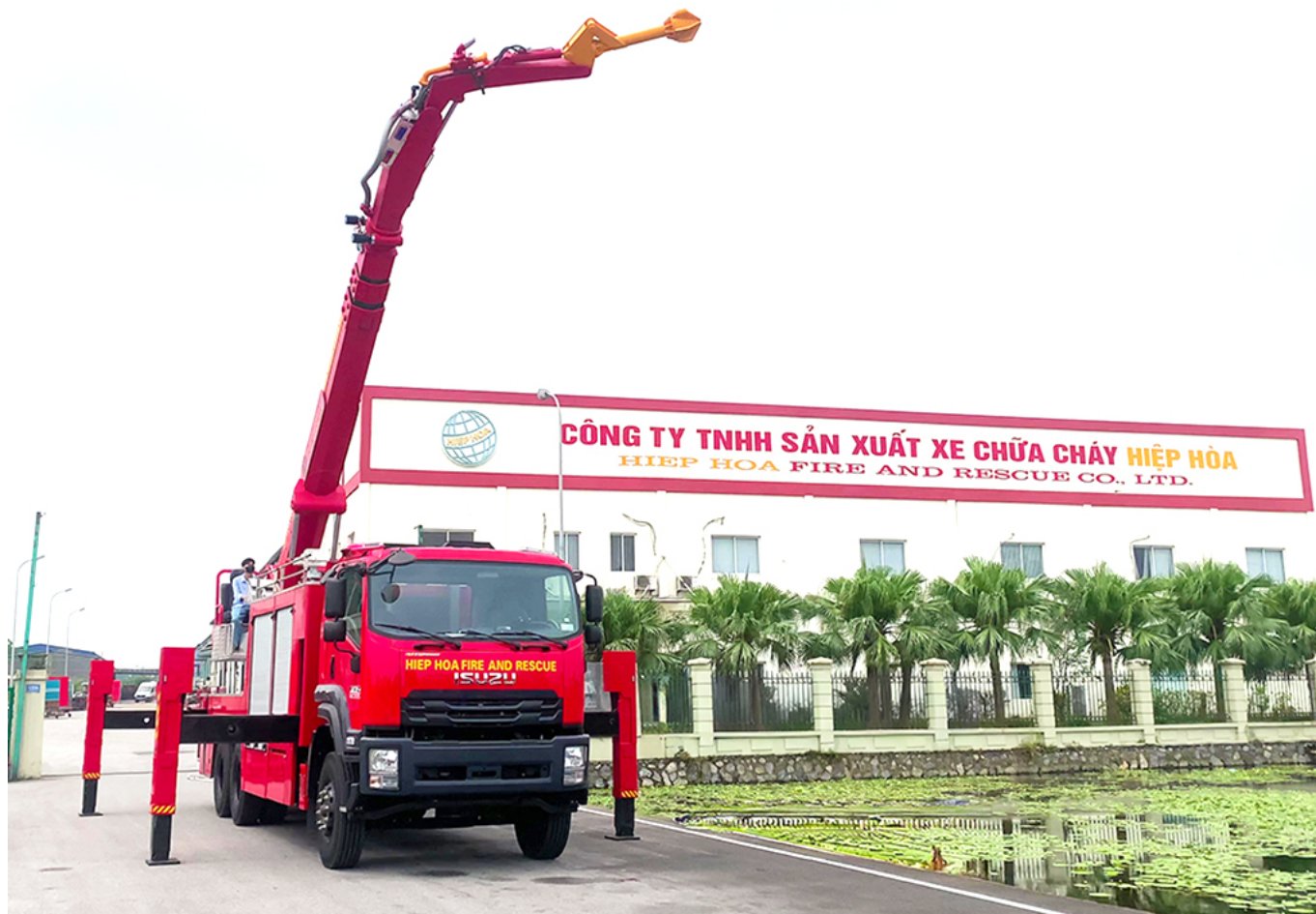
Ảnh: Xe chữa cháy với đầu khoan phá và phun nước
