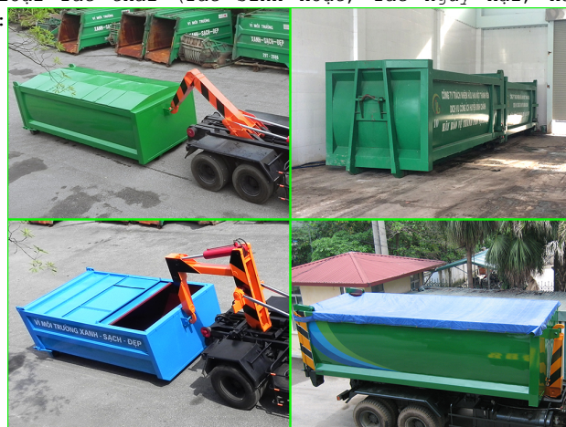
Ảnh: Đa dạng các loại thùng chứa phù hợp với ô tô chở rác Hooklift
