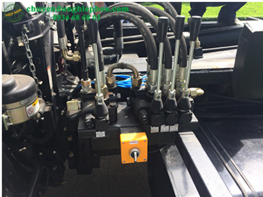
Ảnh: Hệ thống điều khiển thủy lực trên cabin
