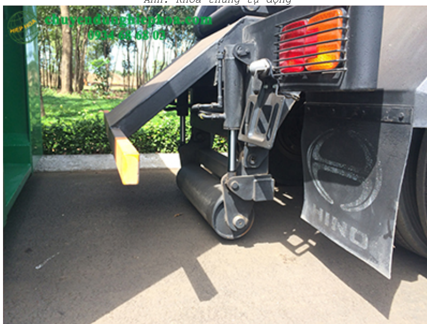
Ảnh: Chân chống an toàn khi cẩu, hạ thùng
