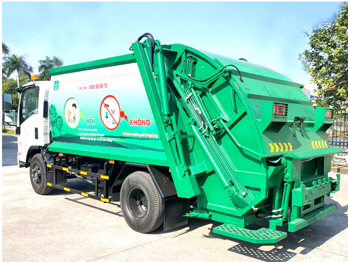
Ảnh ô tô chở rác 6 khối với cơ cấu gấp thùng rác đa năng và nắp đậy ngăn ngừa phát tán mùi
