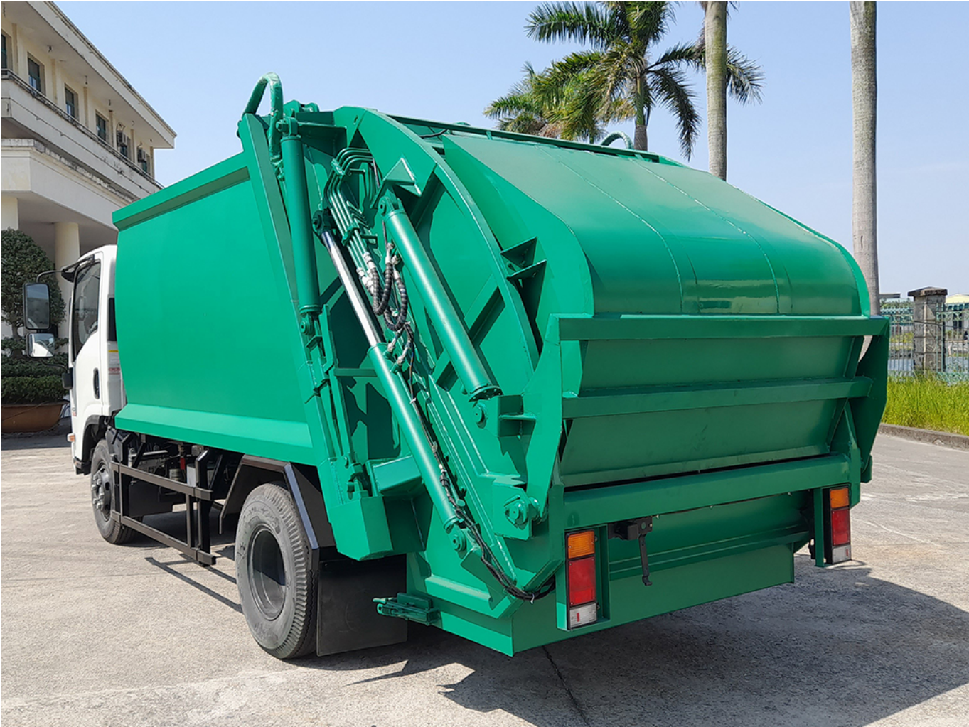
Ảnh ô tô chở rác 6 khối với cơ cấu Máng nạp rác liên thùng
